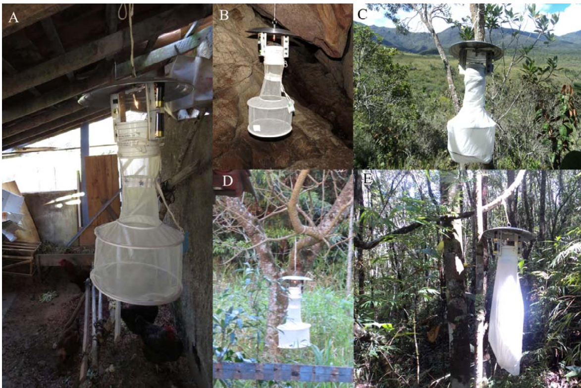
Figura 4 – Armadilhas luminosas do tipo CDC utilizadas nas coletas de flebotomíneos ao longo da RPPN Santuário do Caraça. A – Armadilha disposta em um galinheiro em área peridoméstica; B – Armadilha disposta em zona afótica da Gruta do Bocaina; C e E –
