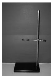
Acessório feito em ferro utilizado em operações como filtração, suporte para condensador, bureta, sistemas de destilação, etc. Serve também para sustentar peças em geral.
