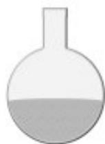
Deverá ser utilizado acoplado a um suporte, uma vez que esse tipo de vidraria não possui estabilidade para ser colocado na bancada sem apoio. Normalmente, é empregado em sistemas de refluxo e evaporação a vácuo, conectado a um roto-evaporador.
