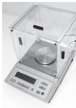
benzina, *thiner* e álcool. Ao transportar o equipamento de um local para outro, sempre trave a balança e procure manuseá-la com cuidado, tomando todas as precauções para reinstalação.
