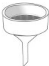
Instrumento de porcelana utilizado em filtrações a vácuo. Pode ser usado com a função de filtro em conjunto com o kitassato.
