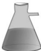
Utilizado em conjunto com o funil de Buchner em filtrações (sob sucção) a vácuo. É constituído de um vidro espesso e um orifício lateral.
