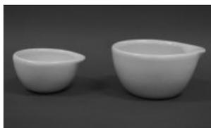
Peça de porcelana que apresenta paredes finas que não resistem ao atrito, usada para evaporar líquidos das soluções e na secagem de substâncias em estufas. Pode ser empregada, também, para a fusão de materiais sólidos e ceras, não devendo ser utilizada na preparação de fórmulas farmacêuticas, pois podem liberar íons.
