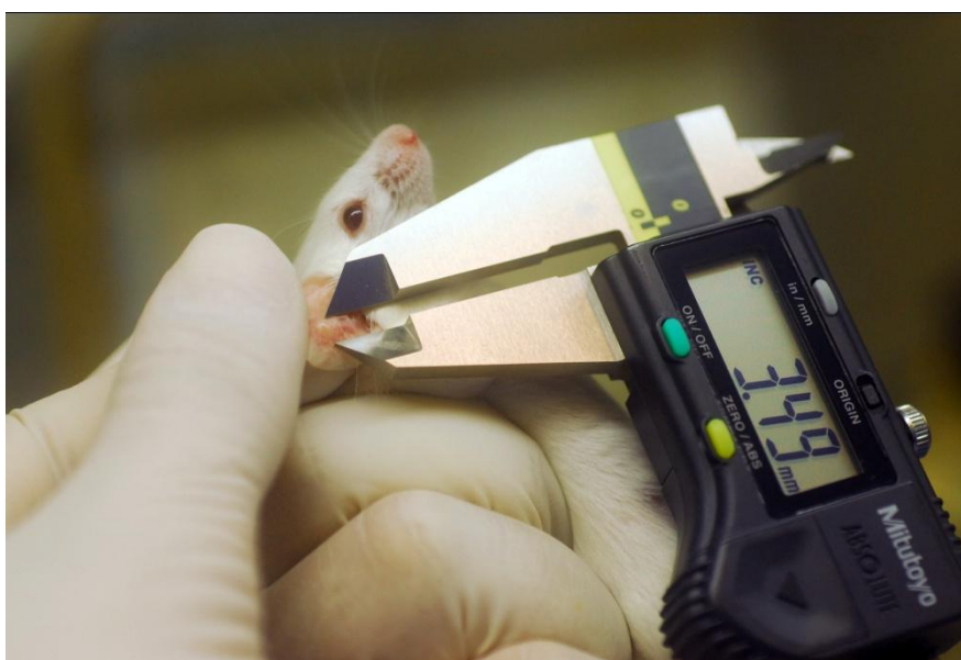
Figura 17- Medição de lesão causada por Leishmania spp. com paquímetro digital
