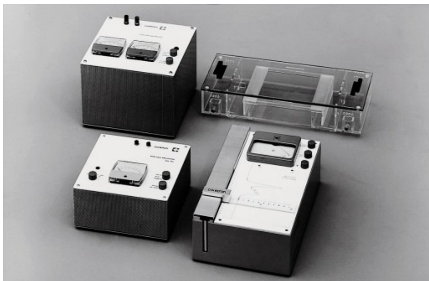
Figura 36 -Equipamentos de bioquímica fabricados pela Coretron nos anos 1960. A peça de acrílico é uma cuba de eletroforese, ao lado de fontes de alimentação para a cuba. Na parte inferior direita, um plotter manual: marcava-se o valor de densidade óptica (indicado pelo galvanômetro) com a ponta de um lápis orientado pela régua.
