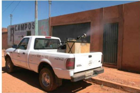
Figura 09. Uso de equipamento nebulizador acoplado a veículo (UBV).
