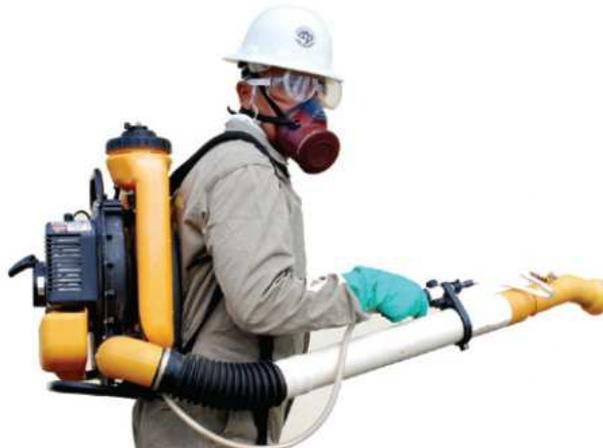
Figura 10. Nebulizador costal motorizado (UBV costal).
