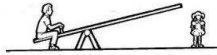
Situação 2 - O apoio está mais próximo da extremidade em que o adulto está sentado.
