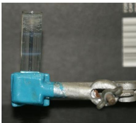
**Figura 8:** Purificação de RVA por gradiente de cloreto de céσιο (CsCl), com densidade de 1,375 (Espejo, López e Arias, 1981; Zárate *et al.*, 2000).
