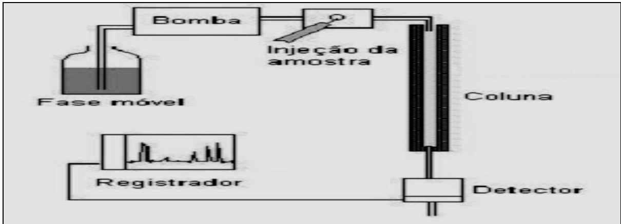
Figura 6 - Estrutura básica de um cromatógrafo líquido de alta eficiência
