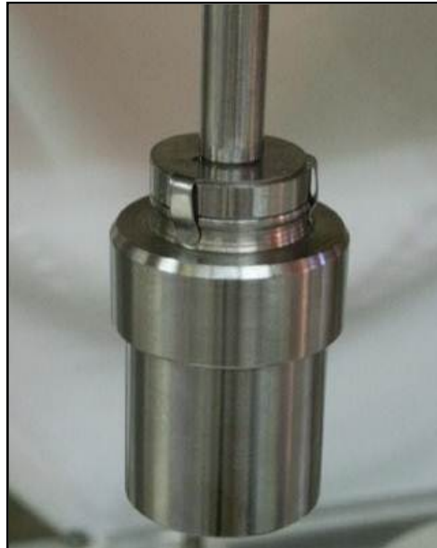
Figura 6: Pastilhador conectado à haste do dissolutor
